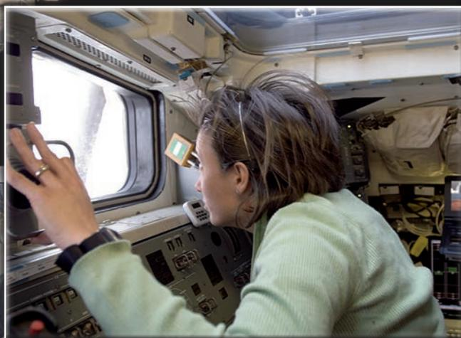
▲ Меган Макартур управляет перемещением астронавта относительно корпуса телескопа, осуществляя визуальный контроль через иллюминатор кормовой палубы шаттла.
